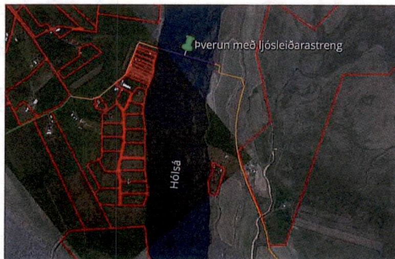
Mynd 1. Þverun Pjórsár og Hólsár með 14 mm ljósleiðarastreng (Pjórsá: 63° 47.209'N, 20° 46.318'W; Hólsá: 63° 43.935'N, 20° 33.785'W).
